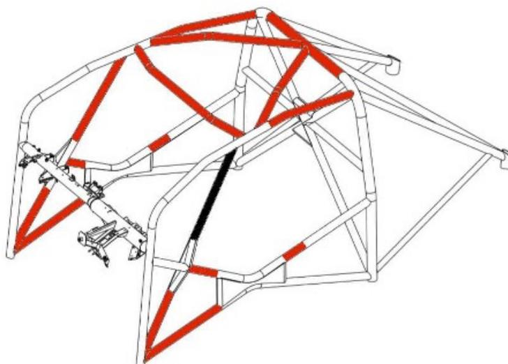
**Figure 1 : Emplacements de la garniture d'arceau**
